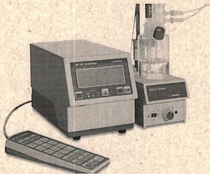
Imagem 02. Titulador automático Metrohm 831 KF Coulometer
