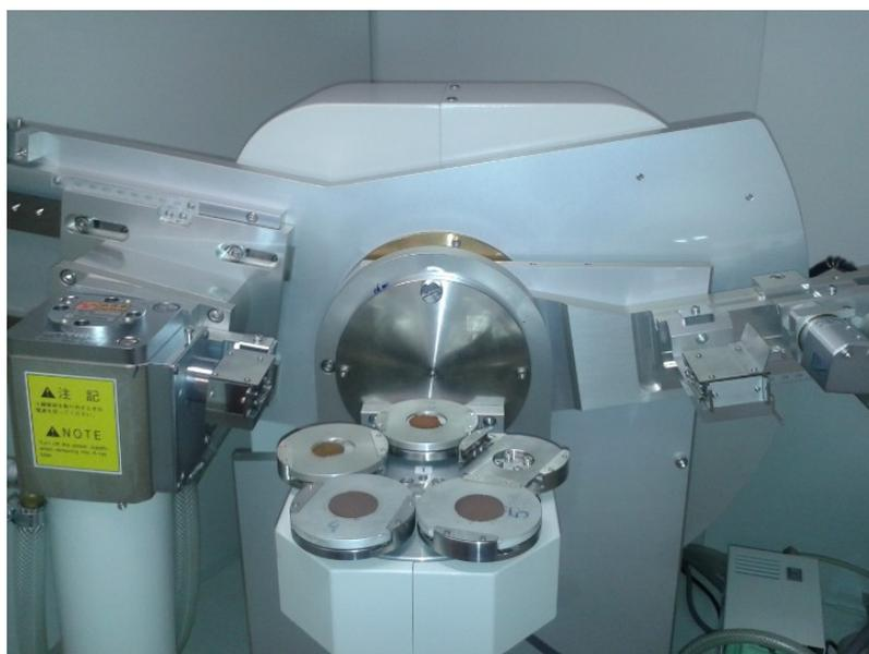
**Figura 2.** Difratômetro de Raios X SHIMADZU XRD-7000.
