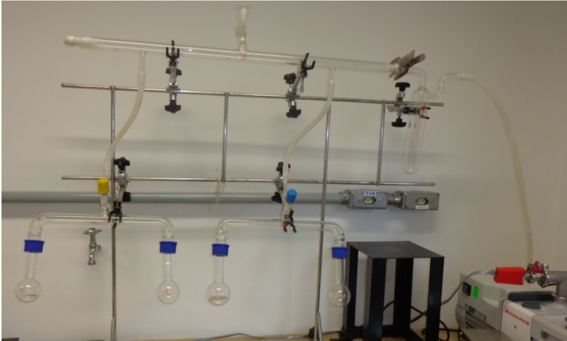
Figura 13: Montagem dos balões para o início do procedimento de destilação.
