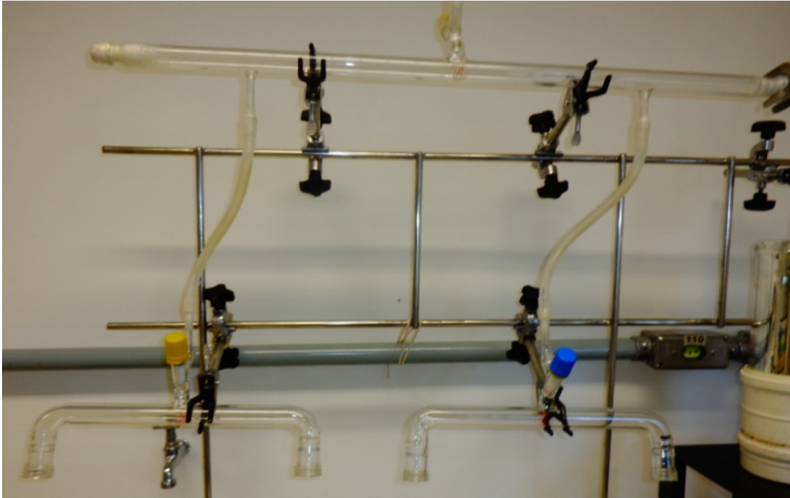
Figura 8: Aparato montado para destilação criogênica.
