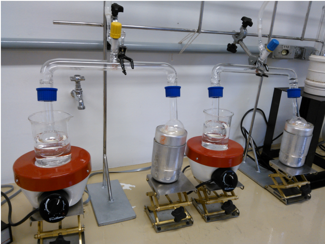
Figura 14: Balões inicialmente continham as amostras, sendo aquecidos e balões vazios sendo resfriados.
