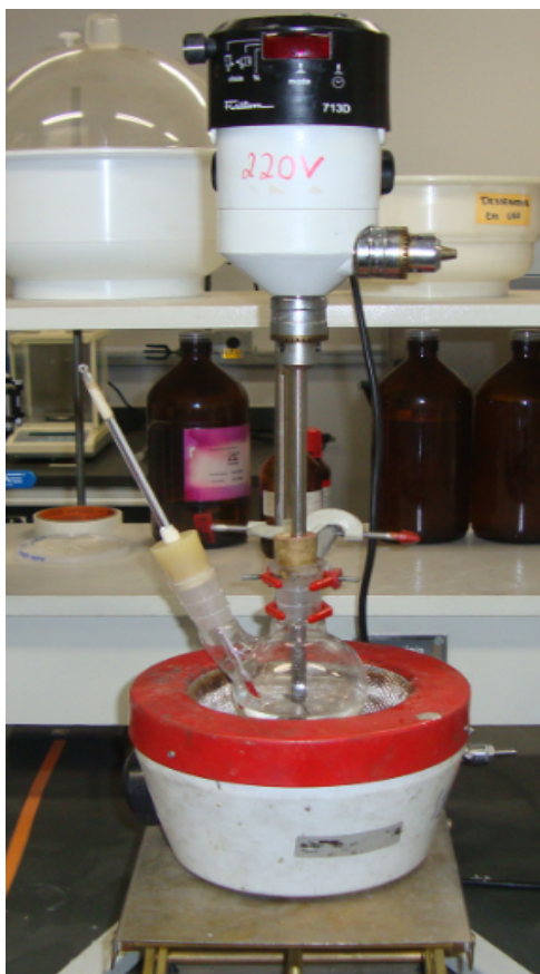
Figura 7 – Montagem da síntese da dispersão aquosa do poliuretano.
