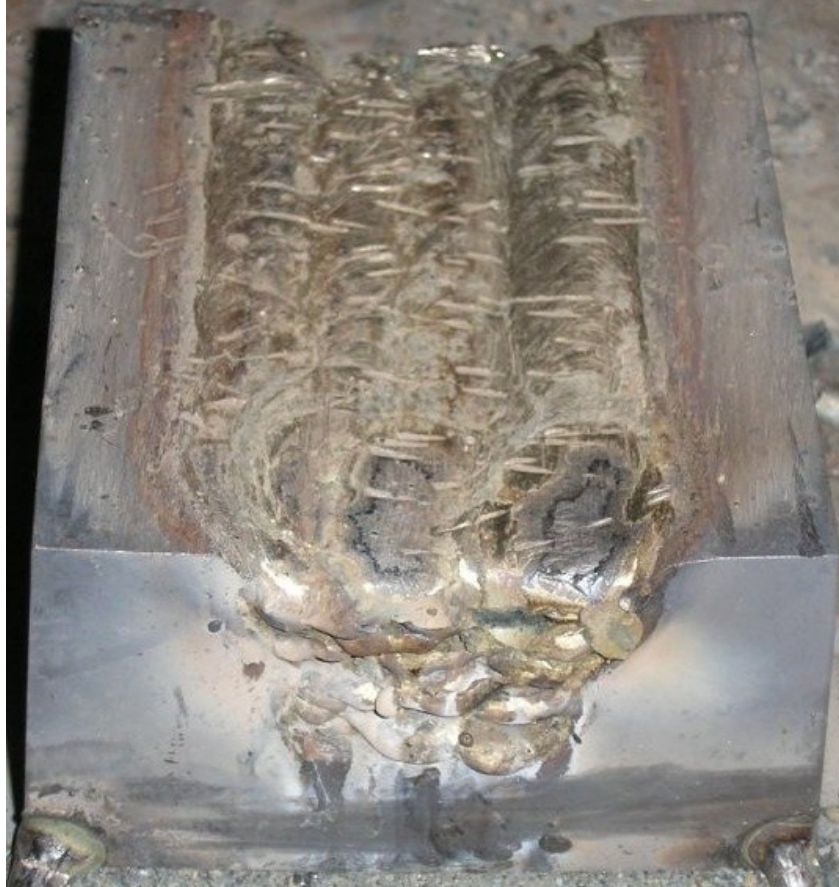
FIGURA 17 – Fotografia do bloco 1 totalmente preenchido com a solda da Liga 182
