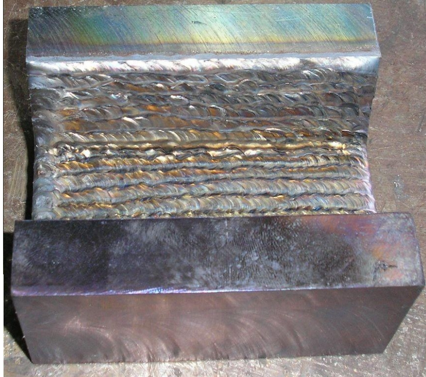
FIGURA 15 – Fotografia de um dos blocos após a etapa de amantejamento com a Liga 82
