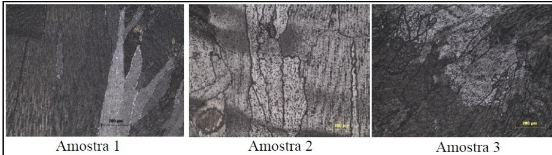
FIGURA 30 – Micrografia das 3 Amostras Após Realização de Ensaio DL-EPR em Solução 0,05M H 2 SO 4 + 0,0001M CH 3 CSNH 2
