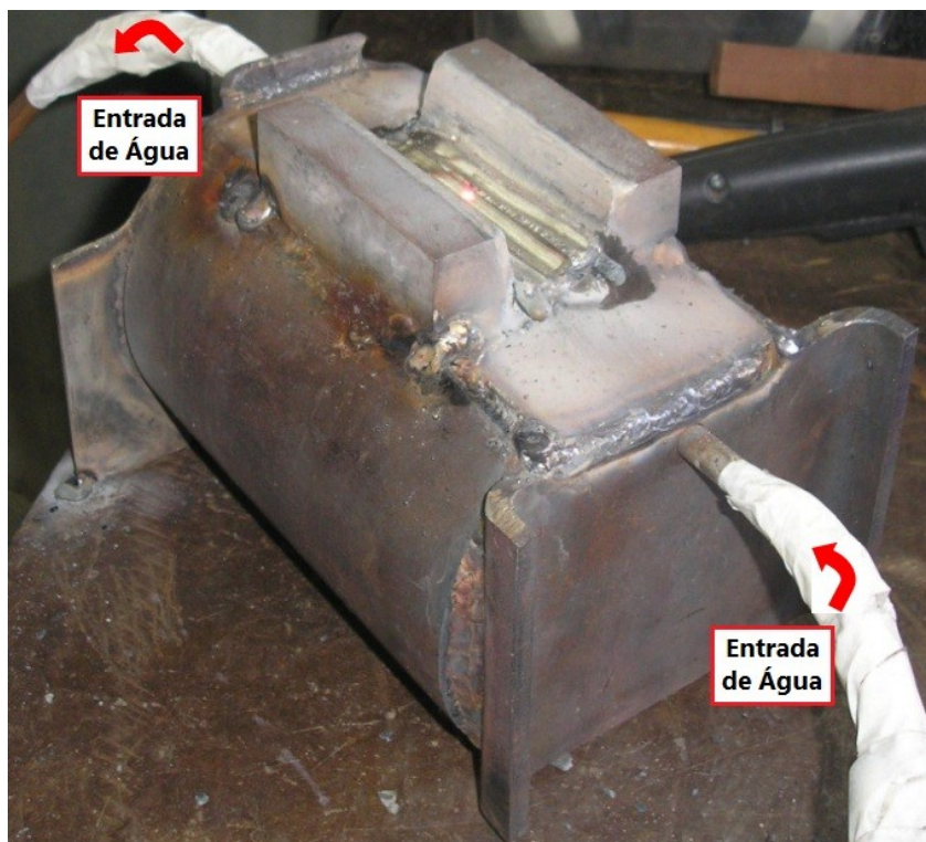
FIGURA 18 – Fotografia mostrando o bloco 3 montado no dispositivo de resfriamento já tendo recebido os primeiros cordões de solda da Liga 182
