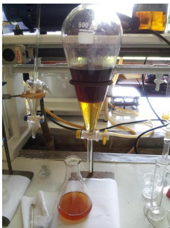
Figura 13 – Extração da fase aquosa(1); fase orgânica(2) inferior e fase aquosa(2) superior.
