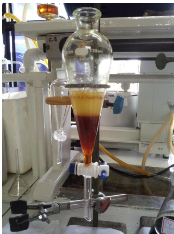
Figura 12 – Extração inicial; fase orgânica (1) inferior e fase aquosa (1) superior.
