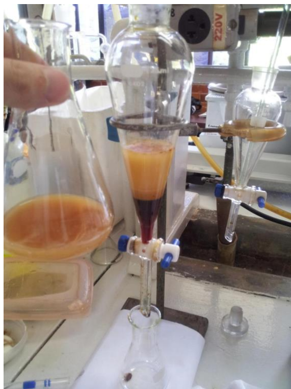
Figura 14 – Extração da fase orgânica (1); fase orgânica (3) inferior e fase aquosa (3) superior.
