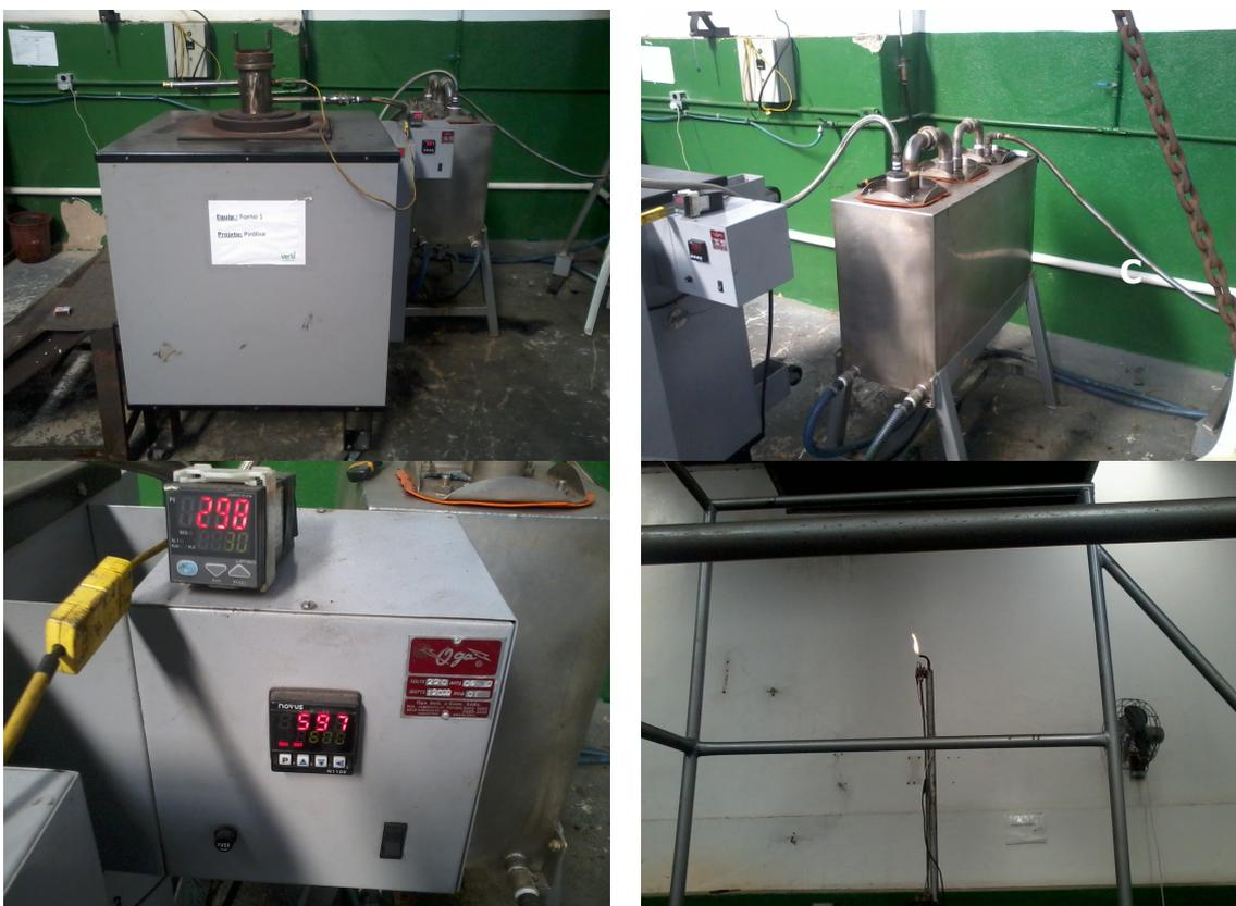
**Figura 6. (A) forno elétrico, (B) condensador dos gases, (C) Termopares e (D) queimador de gases.**
