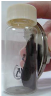
Figura 10 - Nanopartícula magnética exposta a um ímã.
