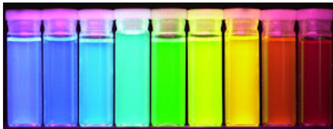
Figura 5 - Emissão de luminescência pelas soluções de "Quantum Dots" de CdSe/ZnS com o aumento das partículas de 2 a 6 nm da esquerda para direita.
