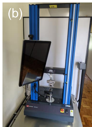
Figura 12 – Esquema de ensaio de tração realizado em um canudo (a) e máquina universal de ensaios mecânicos do laboratório Intechlab (b).
