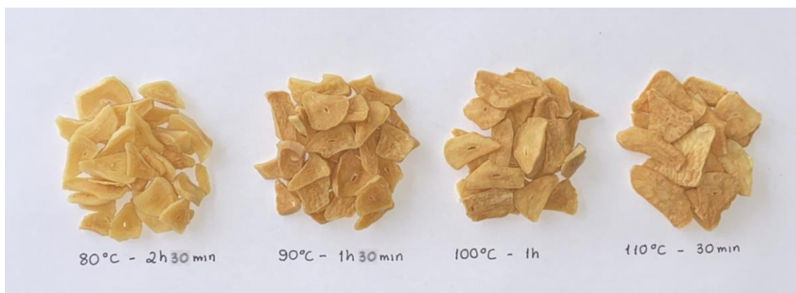
Figura 17 – Resultado da secagem de alho nos pré testes experimentais em 80, 90, 100 e 110 °C
