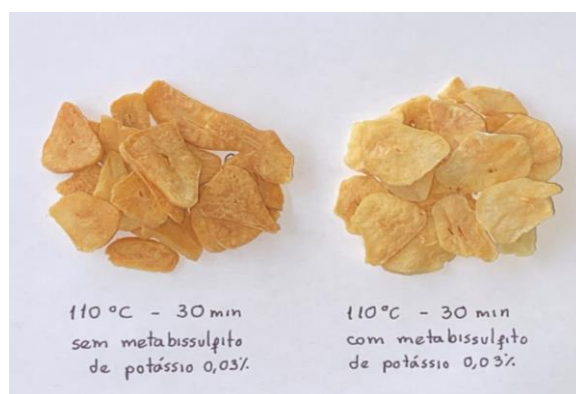
Figura 19 – Resultado do processo de secagem de alho com e sem o pré tratamento com metabissulfito de potássio 0,03%
