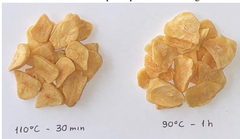
Figura 26 – Resultado do alho após o processo de secagem a 110 e 90 °C
