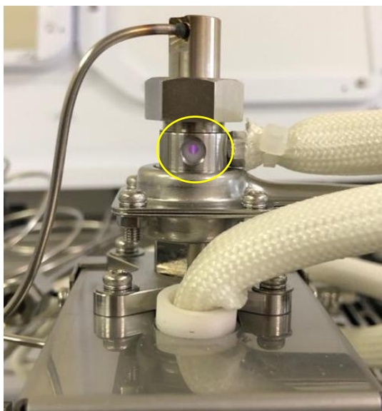
Figura 11: Plasma de Hélio formado no detector BID.
