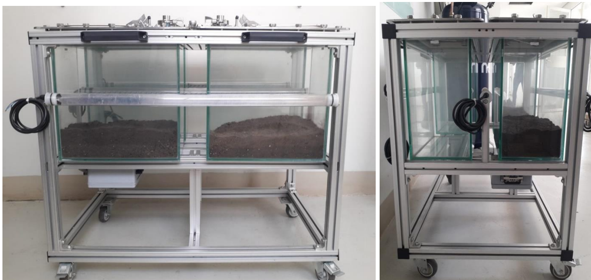
Figura 25: Fotografia da câmara completa antes da umidificação.
