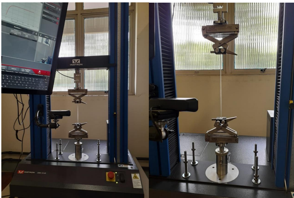
Figura 26: Máquina de ensaios universal realizando ensaio de tração em canudo Intechlab antes da biodegradação.
