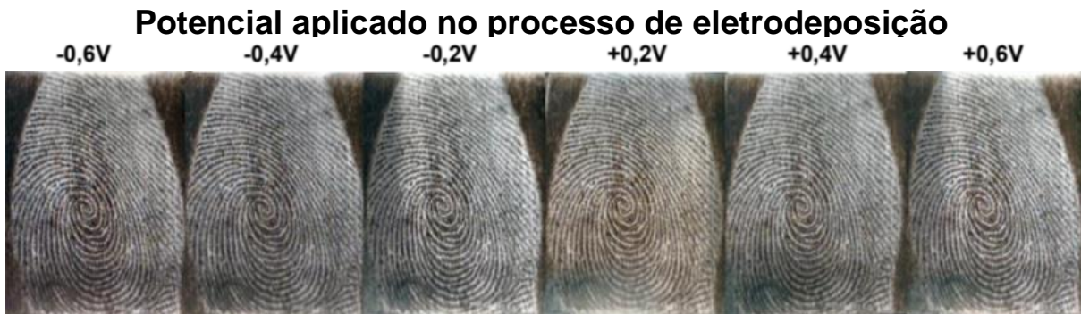
Figura 24 - Revelação de impressões digitais latentes com eletrodeposição do polipirrol dopado com vermelho de metila
