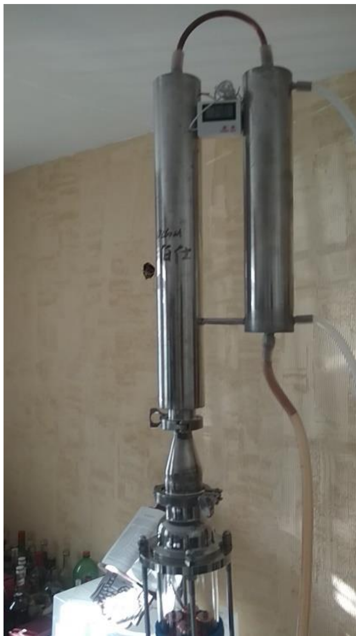
Figura 10 - Condensador de topo
