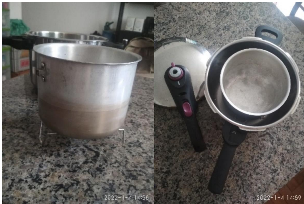
Figura 13 - Montagem para se fazer o banho-maria na panela de pressão
