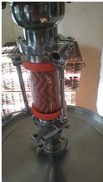
Figura 9 - Demister com malha de cobre
