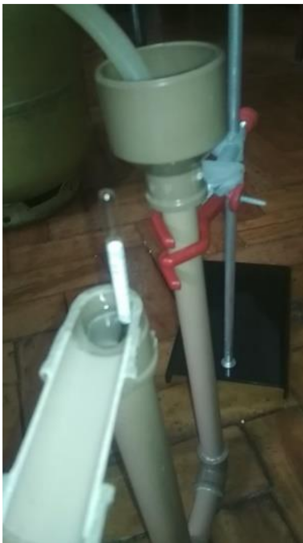
Figura 11 - Bico de papagaio com alcoômetro inserido
