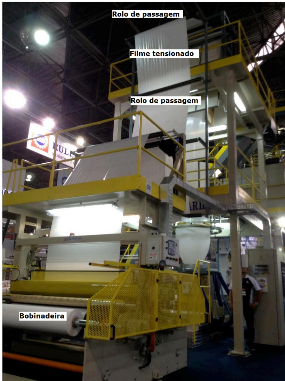
**Figura 35:** Torre para o processo de extrusão de filmes por sopra.
