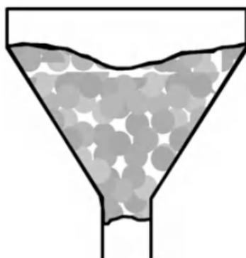
**Figura 15:** Desenho esquemático da formação de uma ponte no funil de alimentação por inundação.
