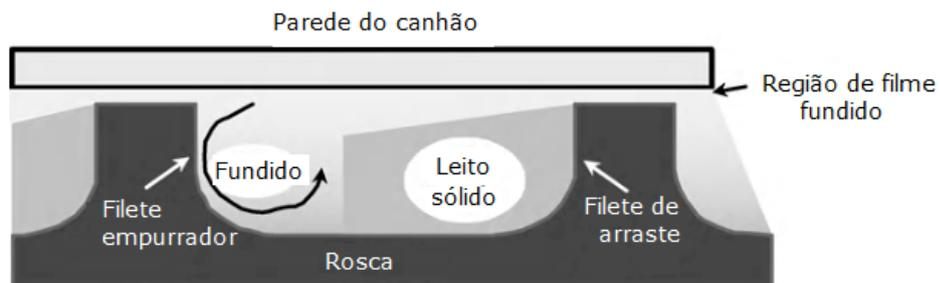
**Figura 21:** Desenho esquemático para o processo de fusão da extrusora.
