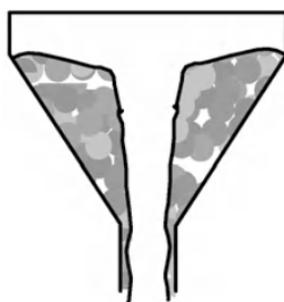
**Figura 16:** Desenho esquemático da formação do afinilamento em um funil de alimentação.
