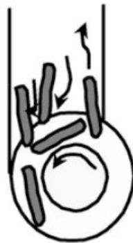
**Figura 20:** Desenho esquemático da ejeção (*ejection*) causada por grandes partículas de matéria-prima elástica.
