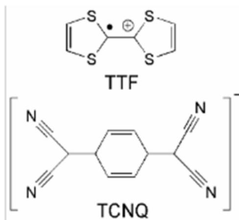
Figura 5: Esquema da estrutura molecular do sal condutor de transferência de carga [TTF] + [TCNQ]<sup>-</sup>.
