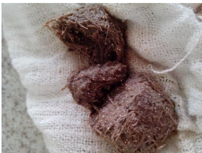
Figura 11 – Fotografia do compósito com pó de PHB ao ser retirado da água.
