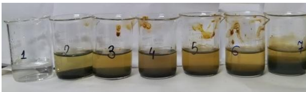
Figura 12 – Alíquotas do experimento 2 (3000 mg/L de NaCl) da Eletrocoagulação.
