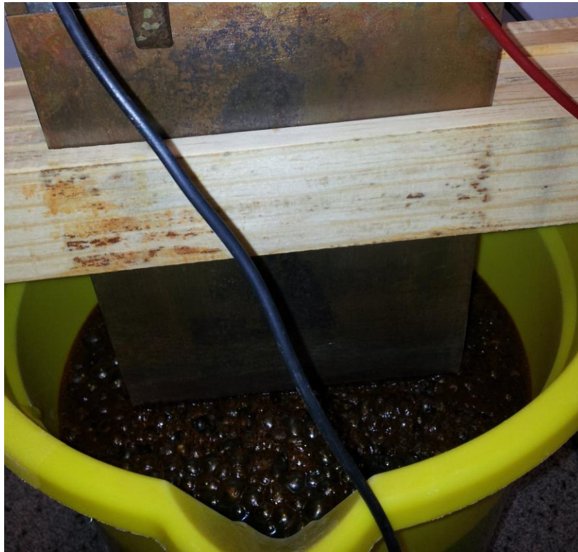
Figura – 13 Efluente sintético durante a reação de Eletrocoagulação.
