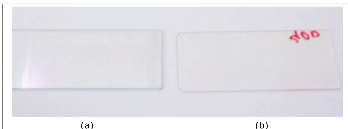
Figura 24 - Filmes finos de \text{TiO}_2 depositados no vidro pelo método (a) Sol-gel e (b) Evaporação e-beam .
