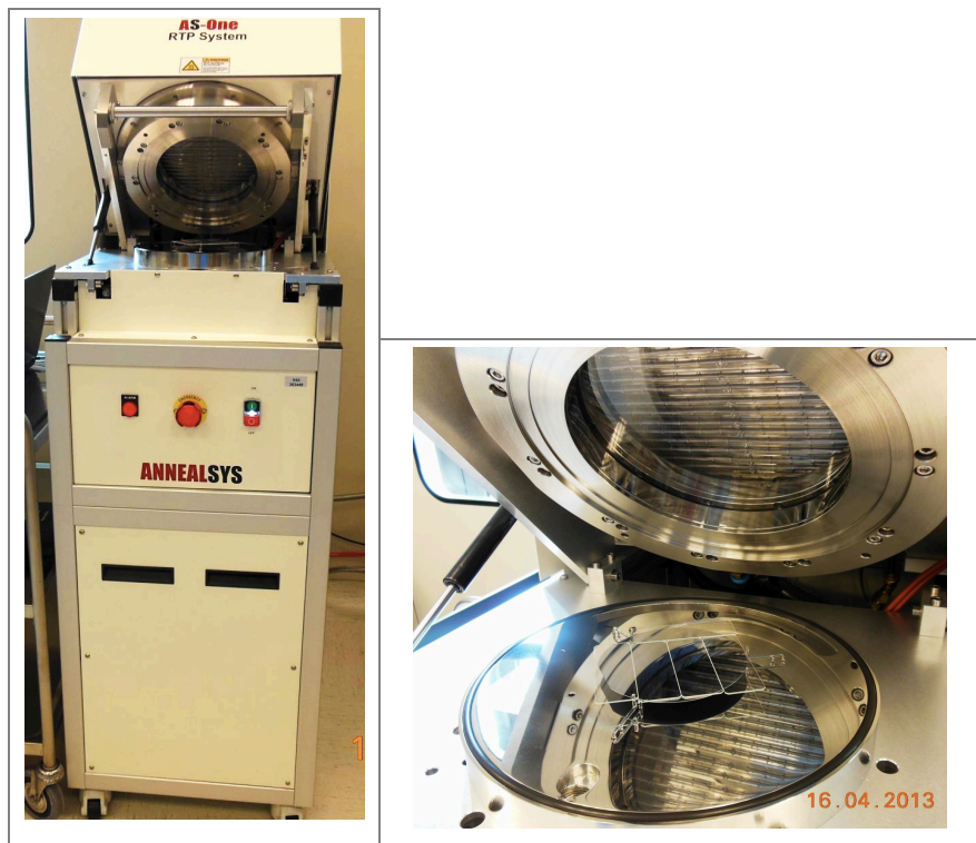
Figura 21 - Equipamento utilizado no tratamento térmico dos filmes de \text{TiO}_2 depositados por evaporação e-beam : RTP - AS-One Annealsys® (Foto cedida pela Profª Angela M. Ferreira).
