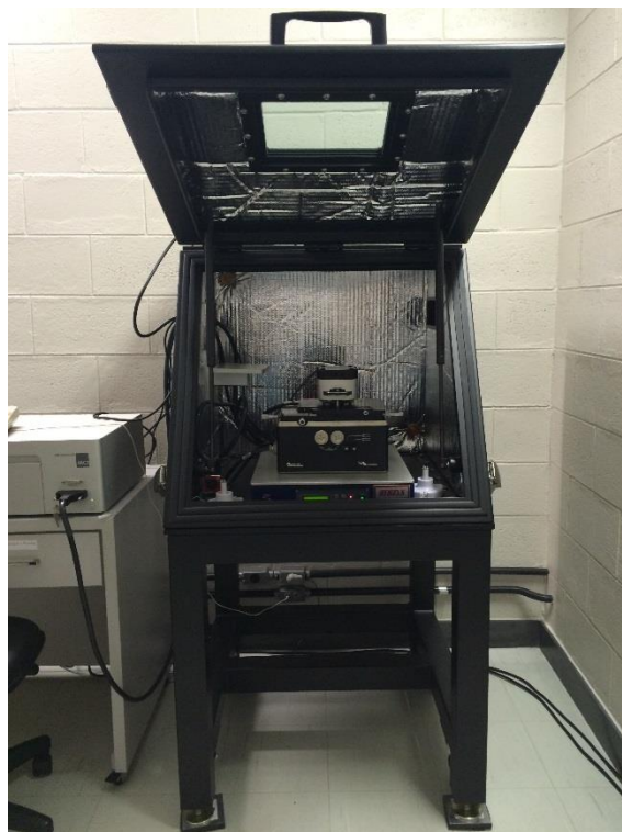
Figura 13. SPM do laboratório ME13 do CM-UFMG em caixa de proteção acústica, mesa antivibratória e microscópio óptico.
