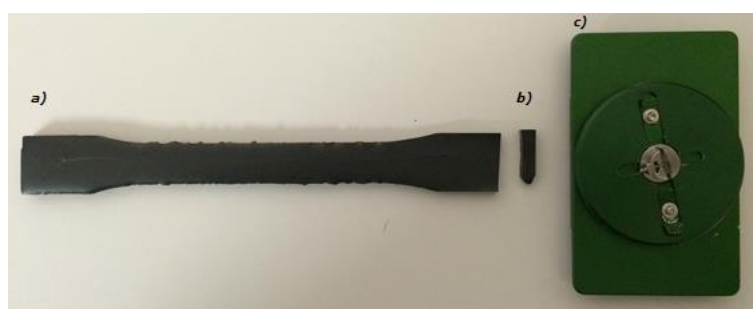
Figura 12. a) Amostra de nanocompósito DGEBA/NTC, b) após o corte manual e c) após o corte em ultramicrótopo, em suporte condutor para SPM.
