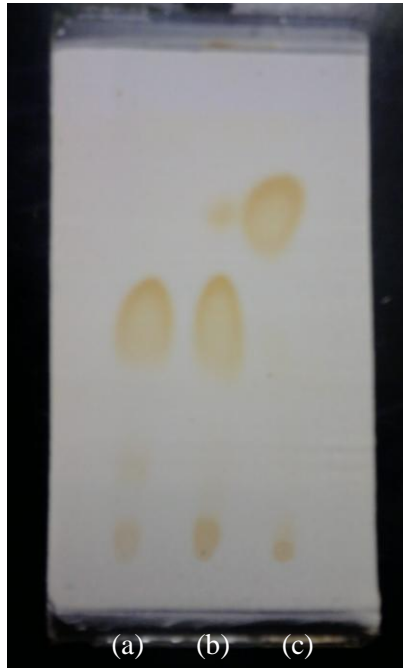
Figura 25 - Placa de CCD. Comportamento do óleo virgem (a) e do produto da síntese em banho de óleo utilizando a Argel ácida 2 e (b) Argel básica 1 e (c).
