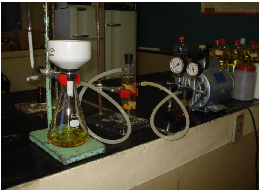
Figura 7 - Montagem de filtração a vácuo
