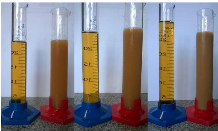
**Figura 23: À esquerda filtração de Baba ESB 1 (esquerda permeado, direita purga), ao centro filtração de Baba ESB 2 (esquerda permeado, direita purga), à direita Baba ESB 3 (esquerda permeado, direita purga).**
