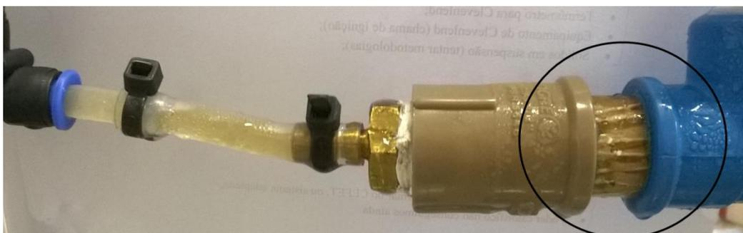
**Figura 21: Saída do permeado do módulo de microfiltração, evidenciando formação de incrustações.**
