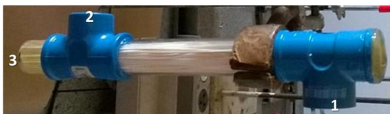
**Figura 14: Vista lateral de um dos módulos de permeação.**
