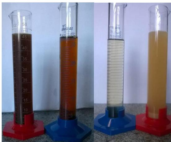
**Figura 22: À esquerda *Belgian Dark Strong* (esquerda purga, direita permeado), à direita filtração de *Blondie* (esquerda permeado, direita purga).**
