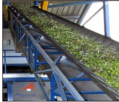
Figura 8 – Sistema de cintas transportadoras. CAMPIÑAS DE JAÉN (2009).
