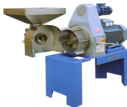
Figura 9 – Moinho utilizado no processo de extração do azeite de oliva. SABOR ARTESANO (2009).
