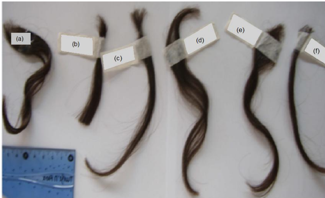
Figura 7: - Fotografias dos fios de cabelo natural e submetidos aos produtos: (a) Branco; (b) Glutaral; (c) Formol; (d) Sódio; (e) Amônia; (f) Guanidina
