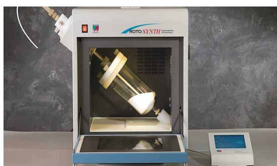
Figura 7 - RotoSYNTH, utilizado para reações em fase sólida ou líquida, com rotação.
