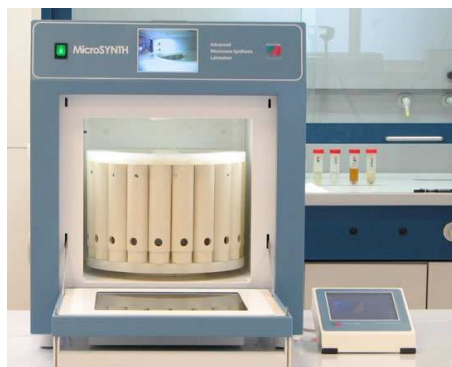
Figura 9 - MicroSYNTH , utilizado para reações em sistema fechado ou aberto, com agitação magnética.
