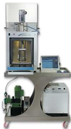
Figura 12 - FlowSYNTH, utilizado para reações em fluxo contínuo Fonte: Milestone (2011)
