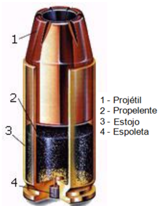
Figura 3 - Composição de um cartucho de fogo central.
