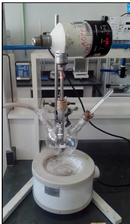
Figura 8 – Montagem da síntese da dispersão aquosa do poliuretano.
