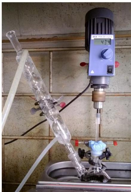
**Figura 9 – Montagem utilizada para a oxidação dos nanotubos de carbono.**
