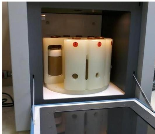
**Figura 9: Forno de micro-ondas (MW) fechado com cavidade usado para a digestão das amostras de sedimentos.**
