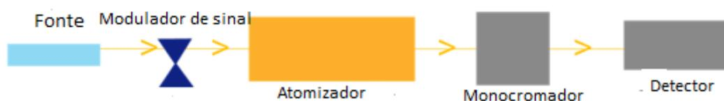
**Figura 3: Esquema representativo de um espectrômetro de absorção atômica com os principais componentes** (Adaptado de BHANOT, 2013).
