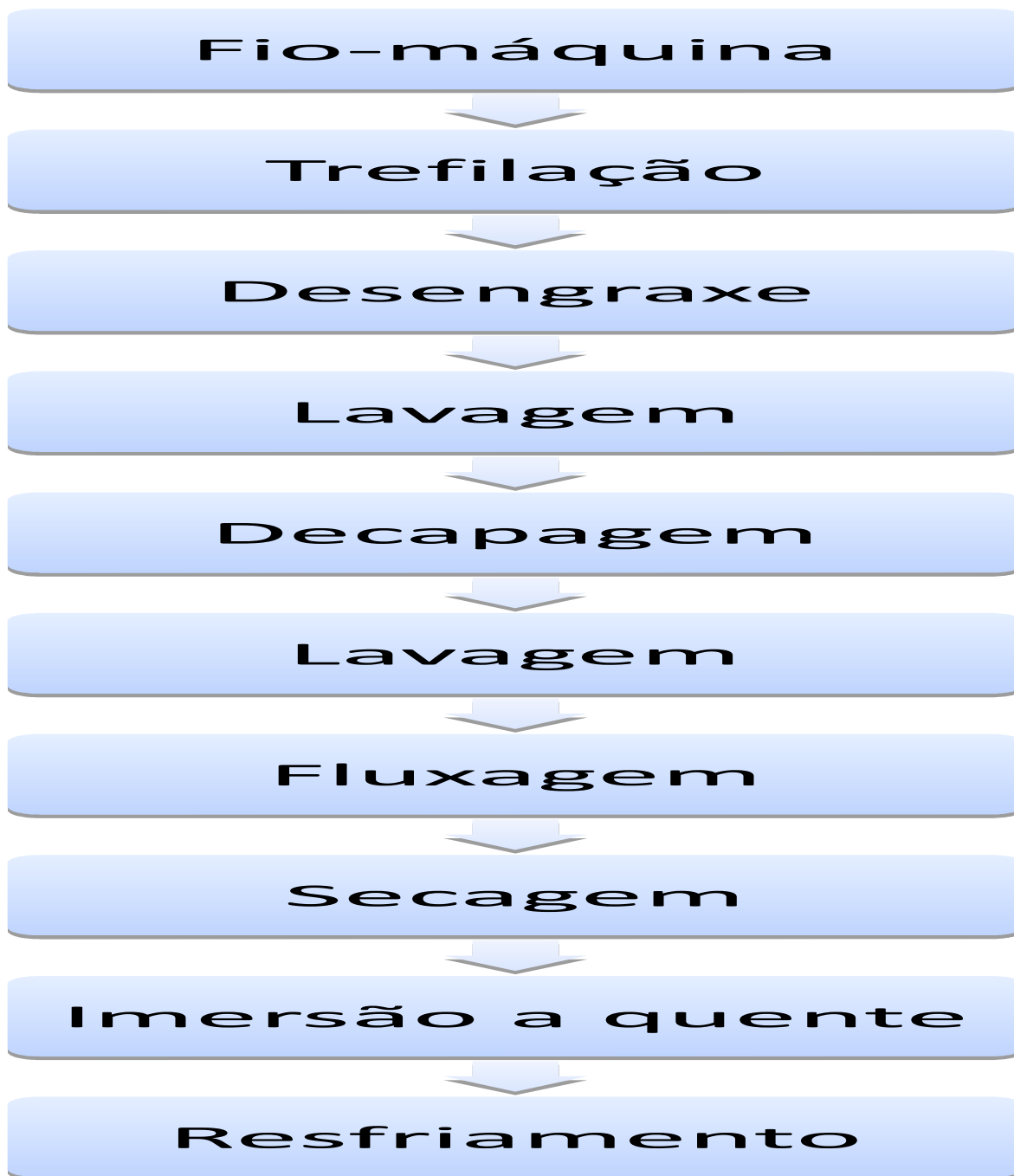
Figura 3 – Etapas do processo de galvanização de arames
