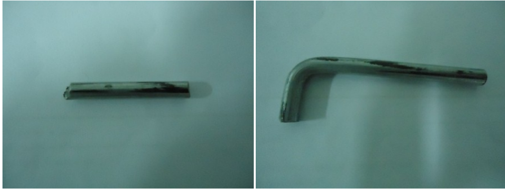
Figura 8 – Fotografias das manchas escuras observadas nas amostras de arames galvanizados de bitola 4,65mm, aço baixo carbono, utilizadas para análise.
