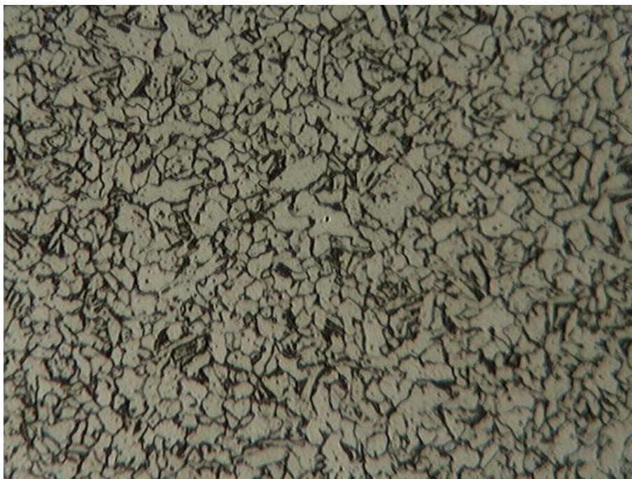
Figura 10 - Imagem de microscópio óptico do aço no centro do arame após ataque com nital, no corte transversal, com aumento de 400x.
