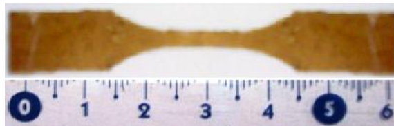
Figura 5: Corpo de prova de tração feito a partir de filmes de colágeno e Whiskers.
