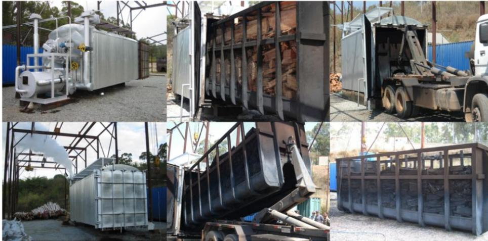
**Figura 6 – Fornos mecanizados com recuperadores de fumaça.**
