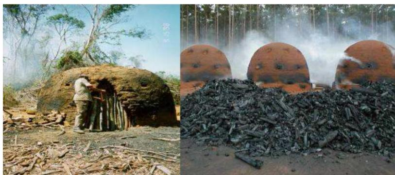
**Figura 5 – Fornos de alvenaria do tipo “rabo quente” de superfície.**
