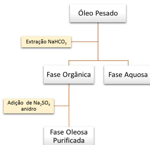
**Figura 12 – Esquema do processo de purificação do óleo pesado.**
