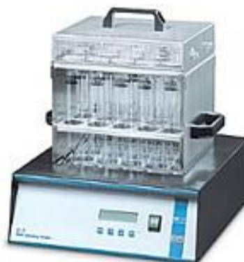
Figura 2: Bloco digestor de proteína
