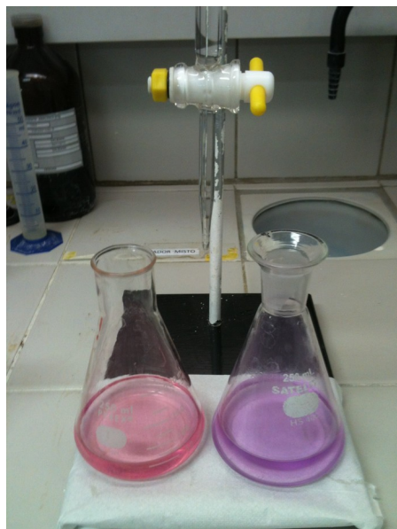
Figura 4 - Comparação da cor inicial da titulação e do ponto de viragem.
