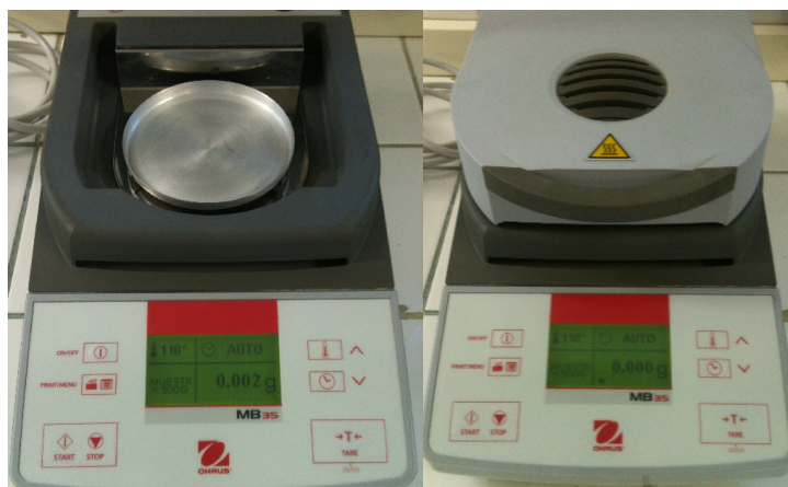
Figura 1 - Balança usada na análise de umidade.
