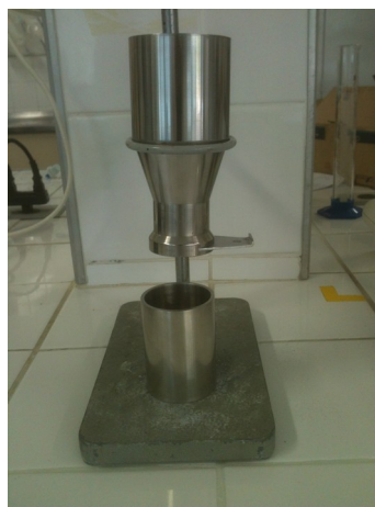
Figura 6- Estrutura para análise da massa específica aparentemente solta.
