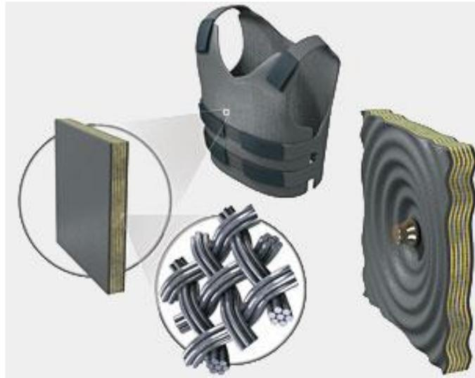
Figura 01: Esquema de colete balístico de Kevlar®. <sup>18</sup>
