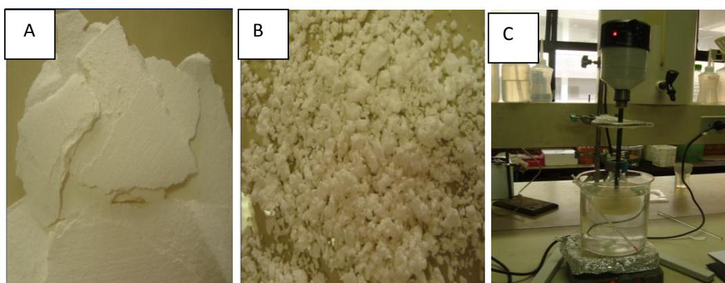
**Figura 15:** (a) Polpa de eucalipto (92-95% de celulose) (b) Polpa de eucalipto purificada (c) Hidrólise ácida da polpa de eucalipto.
