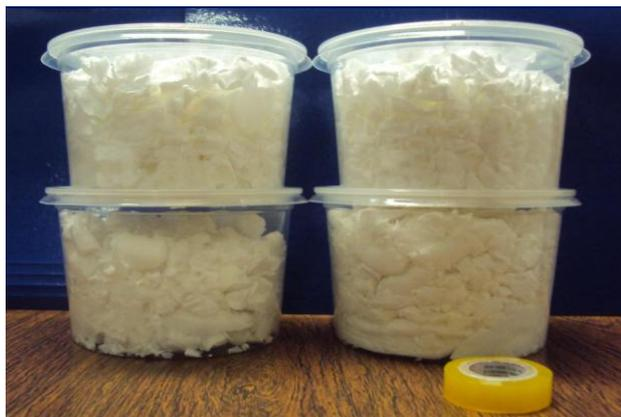
**Figura 16:** Nanocristais de celulose liofilizado.
