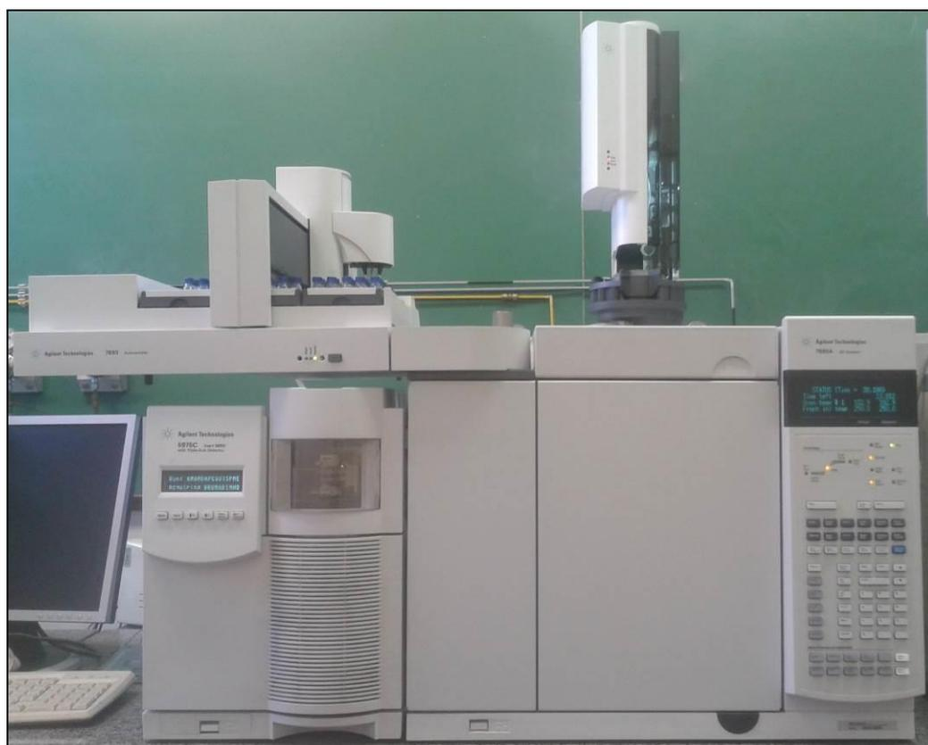
**Figura 11 - Cromatógrafo a gás acoplado à espectrômetro de massas.**
