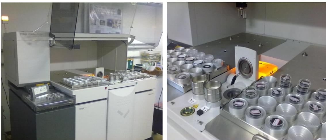
**Figura 12: Espectrômetro de Fluorescência de Raios X**
