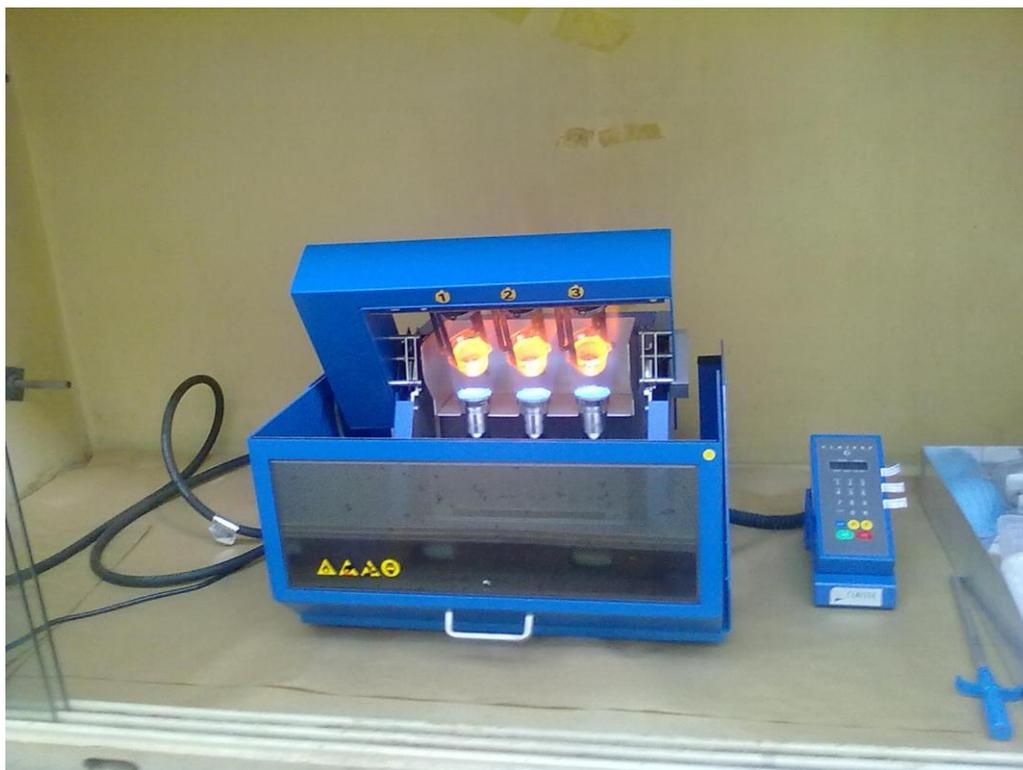
**Figura 11: Máquina de fusão em funcionamento**
