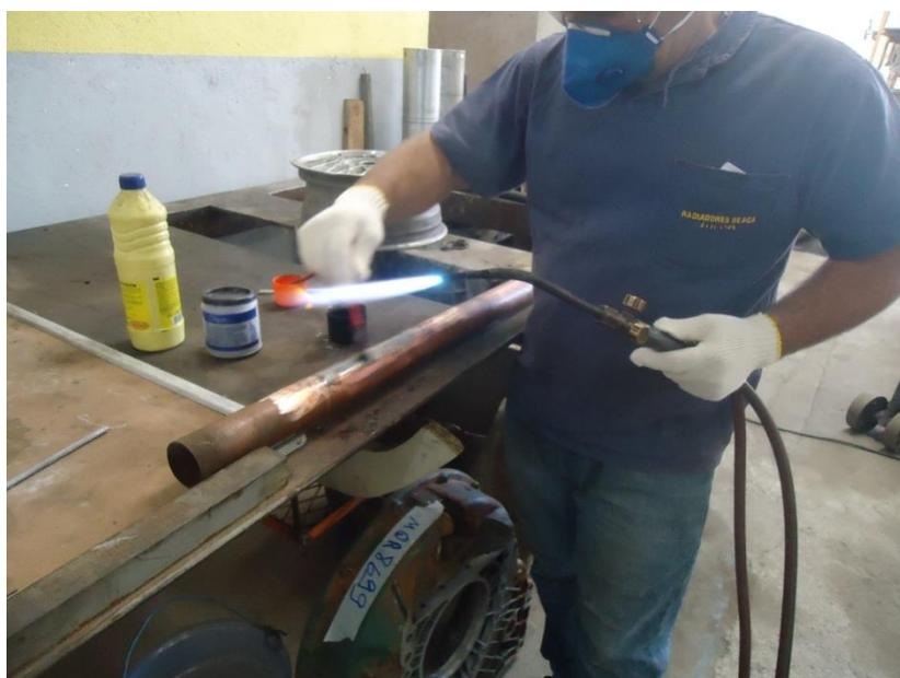
**Figura 13.** Utilização da solda de chumbo na Estação de Trabalho 11.
