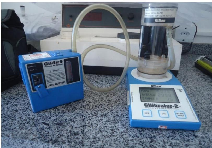
**Figura 12.** Bomba amostradora de ar acoplada ao calibrador de vazão.
