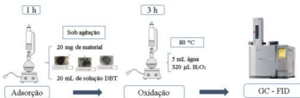
Figura 18 - Esquema experimental para remoção de Dibenzotiofeno.
