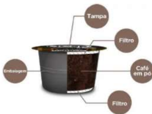
Figura 3 - Estrutura geral de uma cápsula de café e seus componentes.
