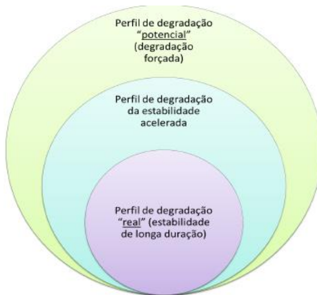
Figura 5 - Relação entre perfil de degradação "potencial", obtido no estudo de estresse, e o perfil de degradação "real", obtido no estudo de estabilidade de longa duração
